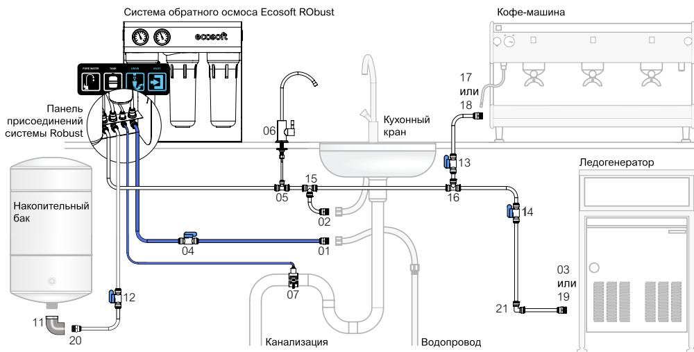
Часть фитингов на схеме поставляются в комплекте к системе ROburst. Фитинги из комплекта дополнительных присоединений могут использованы вместо оригинальных либо вместе с ними, если необходимо подключить накопительный бак с присоединением  $\frac{3}{4}$ " дюйма или более одного устройства-потребителя очищенной воды с присоединениями  $\frac{3}{8}$ " или  $\frac{1}{2}$ ".
